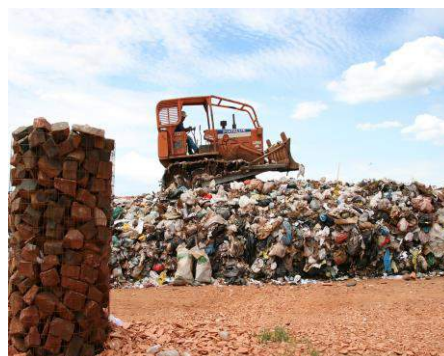
Foto: Trator de esteira compactando o lixo.
